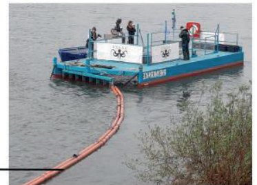
Abbildung 1: Standort und Aufbau der RheinKrake (RK). A) Standort der RK (gelbes Dreieck) bei Köln im Rheineinzugsgebiet (blau), das sich in ein oberes (dunkelblau) und ein unteres (hellblau) Einzugsgebiet unterteilt 14-16 . B) Konstruktionszeichnung und Fotos der angefertigten RK (spiegelverkehrt) mit Eingang auf der linken Seite. Makroabfall (MA) wird in den beiden Körben zurückgehalten. Der schwimmende Leitfangzaun ist mit dem Ufer verbunden und leitet MA zur RK.
